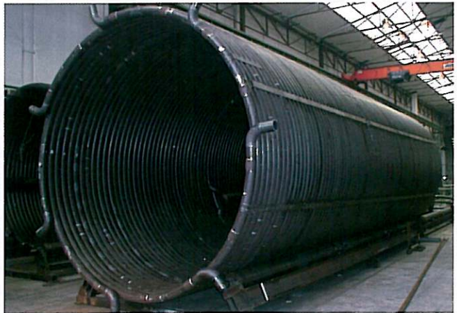
Изготовление змеевиковых труб: Точное изготовление является предпосылкой для выпуска высококачественной продукции.
