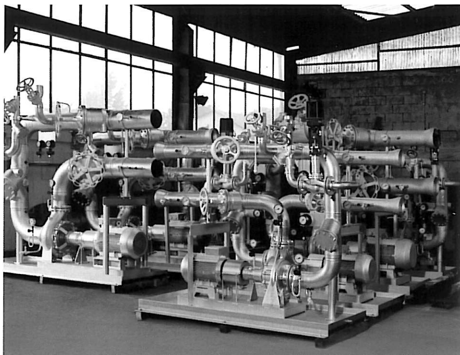
Цепи регулирования для обогрева непрерывно работающего пресса (CPS)
