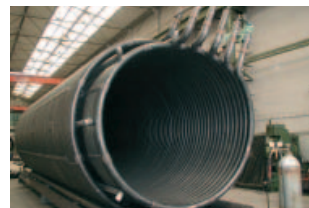
3-Zug-Abhitzeessel mit 8 MW Nettoleistung zur Beheizung einer Produktionslinie für Gummiprodukte
