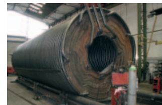
Strahlungskessel mit Einbau- öffnung für Staubbrenner, mit gekühltem Feuerraum- deckel
