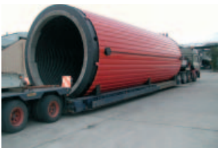
Schleifstaub /erdgasbefeuert er Thermalölerhitzer mit einer Leistung von 16 MW, Aufstellungsland Belgien
