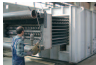
Ziehbares Rohrbündel eines Abhitzeregisters mit auto- matischer Reinigung durch Russbläser
