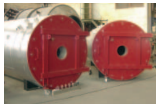
Erdgas- / schwerölbefuehrter Thermalölerhitzer, zur Beheizung einer Polyesterproduktionsanlage in Thailand, 3 MW
