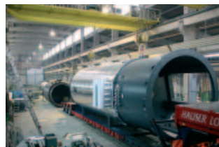
Thermalölerhitzer zur Beheizung einer Spanplattenfertigung in Moskau, Russland, Leistung 12 MW
