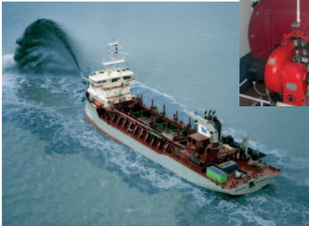
Saugbagger mit Erhitzer 1000 kW und Abhitzekessel 860 kW
