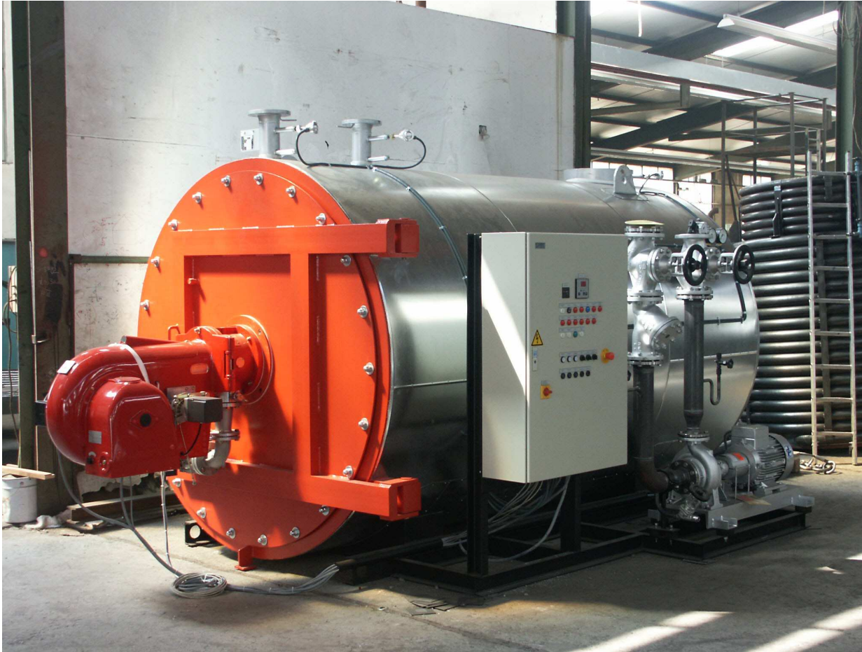
Erhitzer mit Tür, Weishaupt-Leichtölbrenner Schaltschrank u. Pumpe Heater with front door, Weishaupt light oil burner, switch panel and pump
