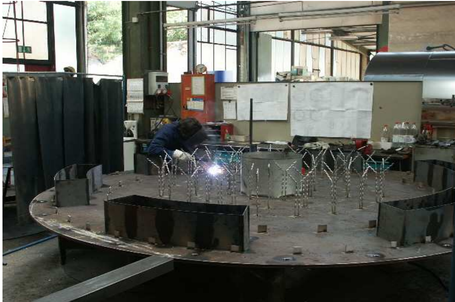
Fertigung einer Brennermuffel, Teil 1/3 Production of a Burner Muffle, step 1/3
