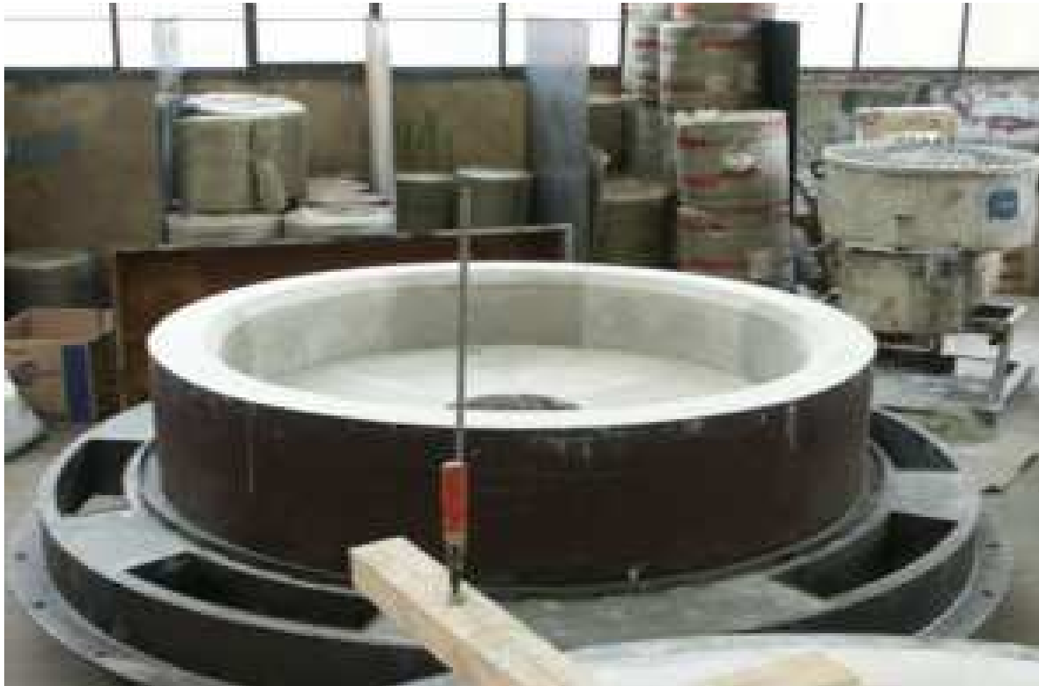
Fertigung einer Brennermuffel, Teil 3/3 Production of a Burner Muffle, Step 3/3
