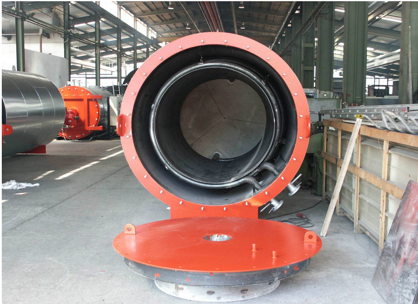
Erhitzer mit geöffneter Frontplatte Heater with opened front plate
