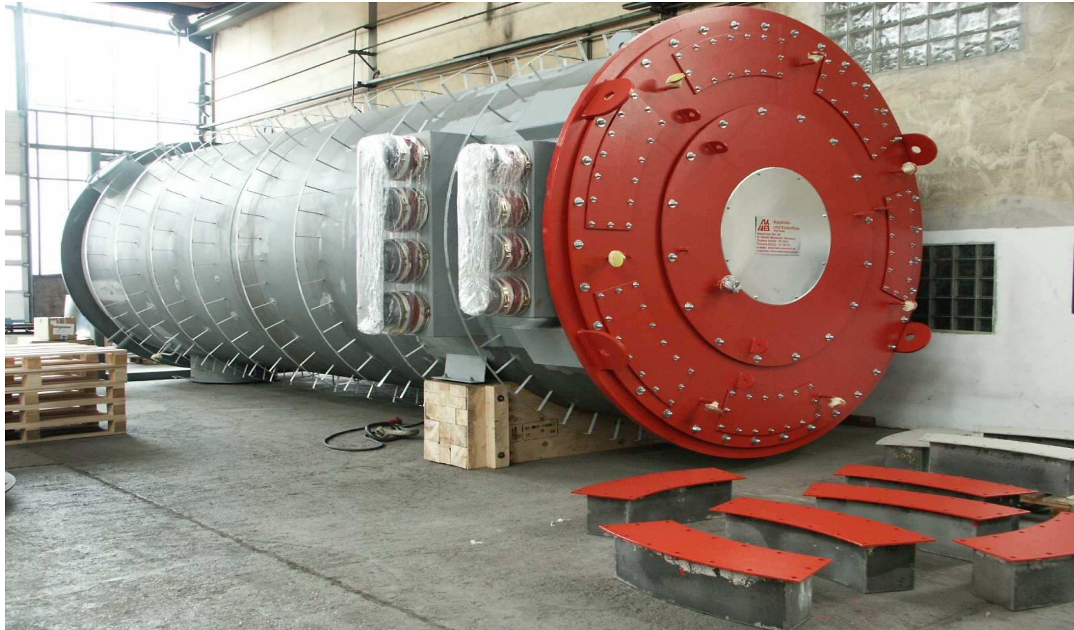
Erhitzer mit abnehmbaren Reinigungssegmenten 8.000 KW Hot oil heater with removable cleaning segments
