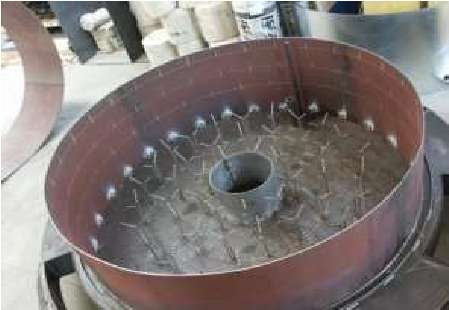
Fertigung einer Brennermuffel, Teil 2/3 Production of a Burner Muffle, Step 2/3
