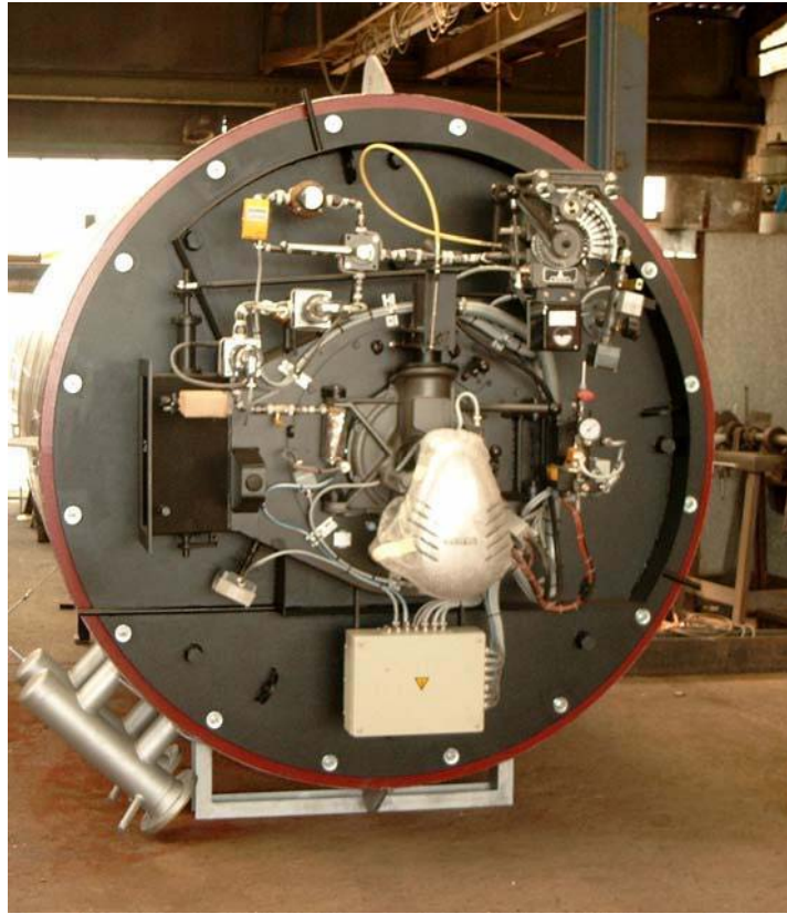
Proyecto K 0404 Portacontenedor para Polonia, calentador de aceite térmico de una capacidad de 2.200 kW.
